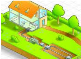
Assainissement non collectif
